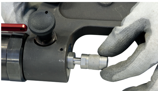
Atornillar la prolongación incluida con el brazo.
