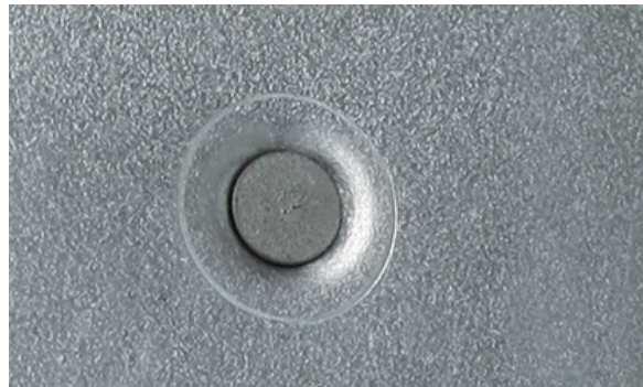
RESULTADO AL PONER UN REMACHE AUTOPERFORANTE
