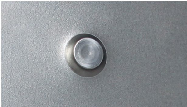
RESULTADO AL PONER UN REMACHE AUTOPERFORANTE
