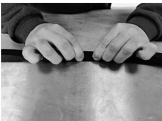
Verificare che la guarnizione sia inserita correttamente nella scanalatura.
