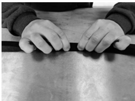
Controleer of de afdichting correct in de groef is geplaatst.
