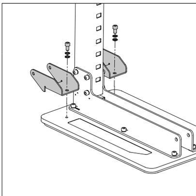
Atornille los soportes de las ruedas a la placa utilizando una llave H8 BTR.
