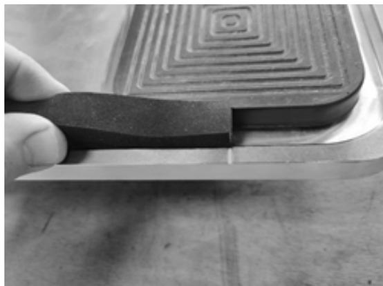
Druk de afdichting op zijn plaats in de groef.
