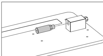
Schroef de geluiddemper met de hand op het venturiblok
