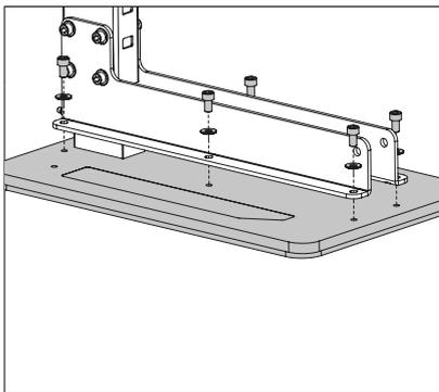
Atornille el conjunto mástil / soportes a la placa base utilizando una llave H8 BTR.
