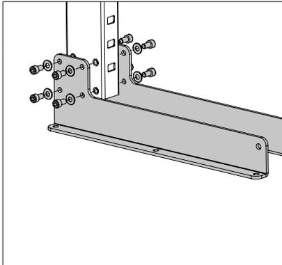
Atornille los soportes izquierdo y derecho a la base del mástil utilizando una llave H8.
