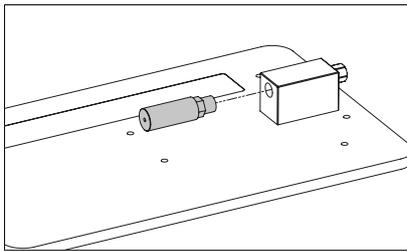
Schrauben Sie den Schalldämpfer mit der Hand auf den Venturi-Block.
