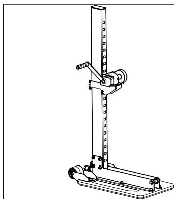
Bringen Sie den Fahrwagen mit der Winde am Mast an.
